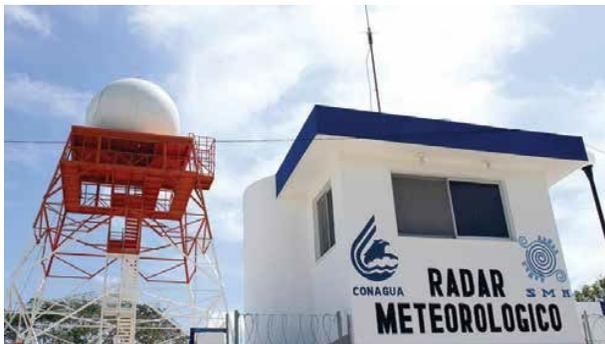
Los radares meteorológicos dan seguimiento a los sistemas nubosos y recolectan información sobre la intensidad de las precipitaciones, la altura y la densidad de las nubes, sus desplazamientos y la Velocidad y dirección de los Vientos.
